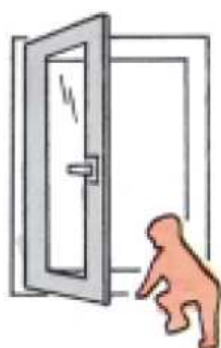
Fig. 7 Indien kleine kinderen of geestelijk gehandicapten toegang tot het raam hebben, dan het raam in de draaistand beveiligen door een afsluitbare greep toe te passen en deze in de dichte- of valstand te vergrendelen.
